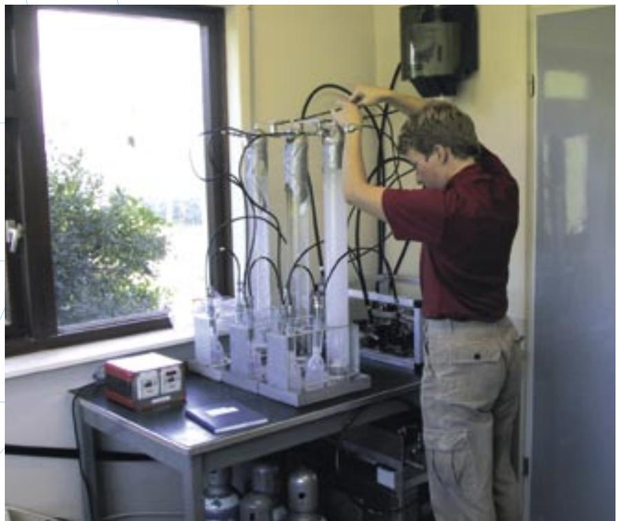
*In der atmosphärischen Überwachungsstation Lutfjewad an der Nordseeküste (Niederlande) werden zweimal wöchentlich CO<sub>2</sub>-Proben genommen, wobei CO<sub>2</sub> in Natriumhydroxid gebunden wird.*
