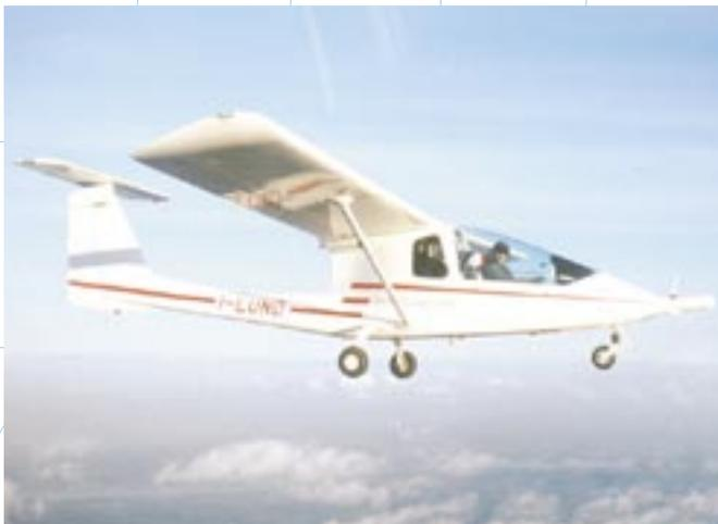
SkyArrow, das kleinste Forschungsflugzeug der Welt, misst die Flüsse von CO<sub>2</sub> und Wasserdampf.
