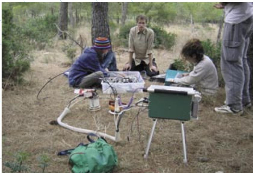
Wussten Sie, dass der Boden atmet? Mit dieser „Bodenkammer“ messen wir, wie viel  $\text{CO}_2$  vom Boden auf Pianosa freigesetzt wird.
